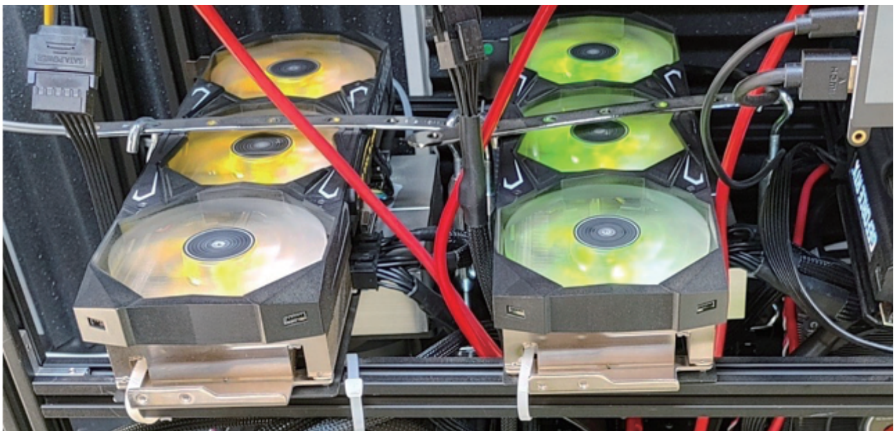
ディープラーニングサーバー（20992 個の CUDA コアを備えた GPU アレイ）
